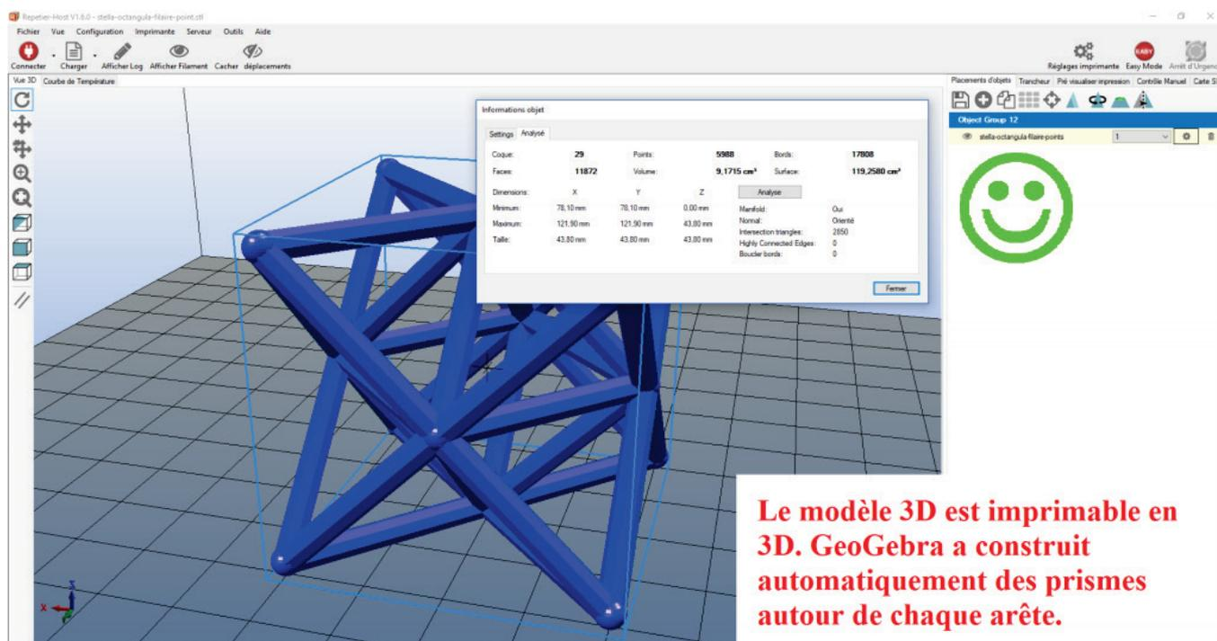
L'analyse effectuée par un logiciel d'impression 3D, ici Repetier Host, permet de dire que le modèle 3D filaire, avec les paramètres par défaut dans GeoGebra classique, est imprimable en 3D.
