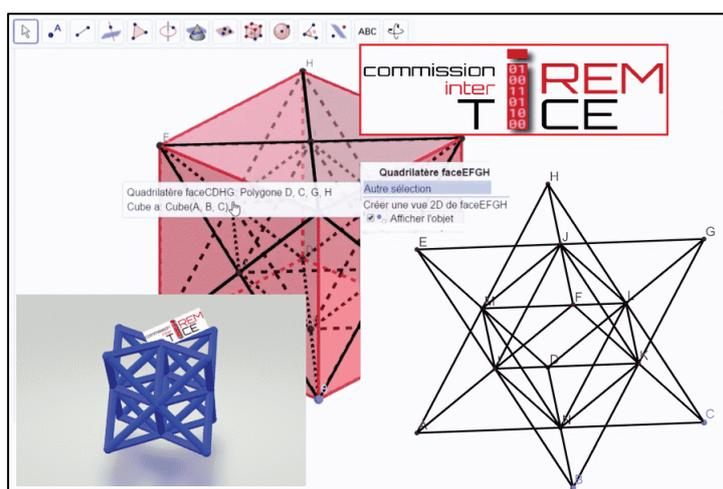
GeoGebra permet de générer des modèles 3D imprimables en 3D dont le résultat est un solide "en mode filaire". L'exemple d'une stella octangula est traité dans cet article.
